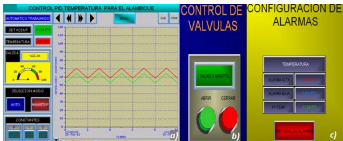
Figura 5.- Interfaz de la pantalla touch, a) Control PID de la válvula de vapor, b) Encendido y apagado de la válvula de alcohol, c) Manejo de alarmas.
