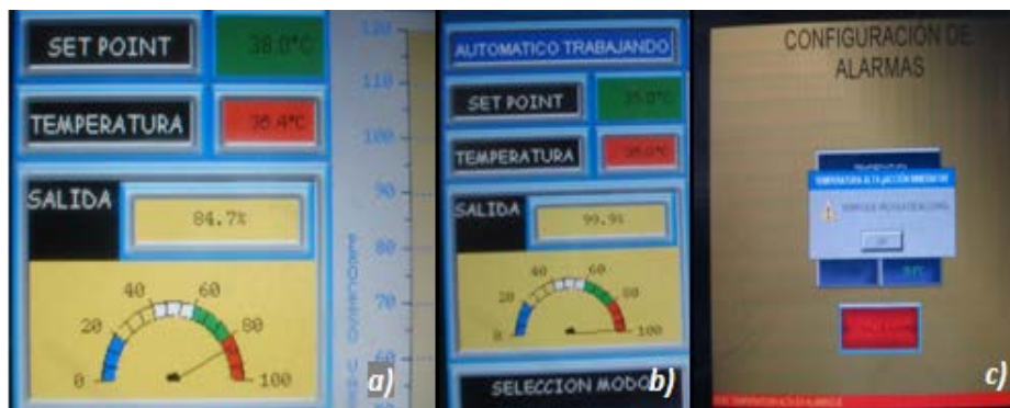
Figura 7.- Control automático de la temperatura, a) salida al 84.7% ya que falta poco para llegar a una temperatura de 38 °C, b) salida al 99.9 % puesto que ya llegó a la temperatura deseada, c) alarma de temperatura alta, que indica que hay que verificar la válvula de vapor.
